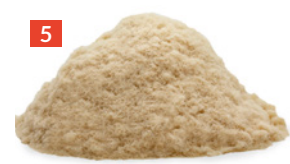
GUTEX Thermofibre® houtwol inblaas isolatie in gesloten compartimenten of in open geblazen vorm voor horizontale vlakken
