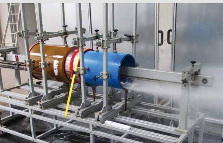
Hochdruckpülversuch nach DIN 19523 bei der iro GmbH Oldenburg
