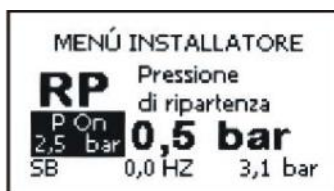
Afbeelding 11: instelling van de druk voor herstart
